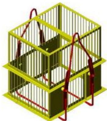
**Габаритные размеры захвата:** (1120x1245x1365)
